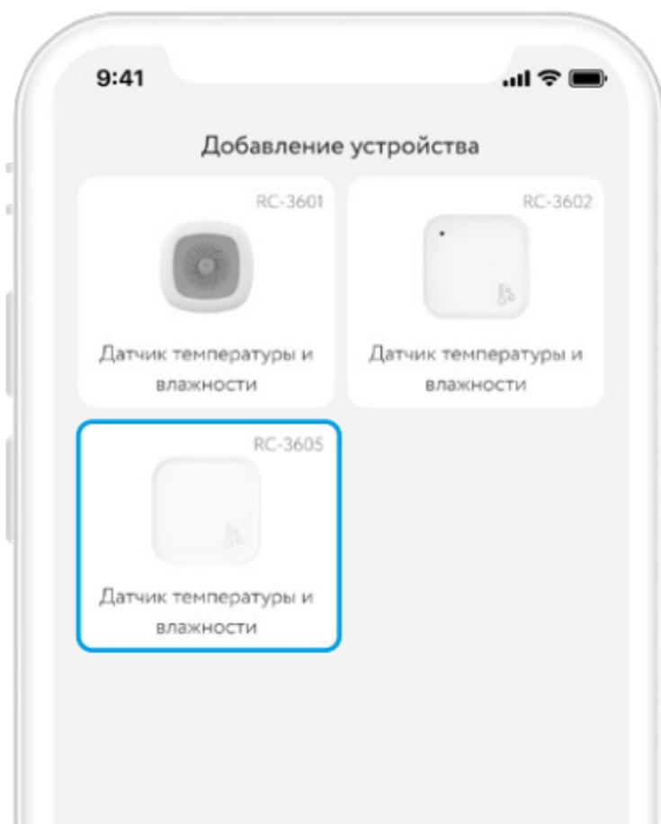
6. Чтобы перевести датчик в режим добавления нажмите на кнопку 10 и более раз с интервалом между нажатиями менее 1 секунды. Диод датчика должен начать мигать.
