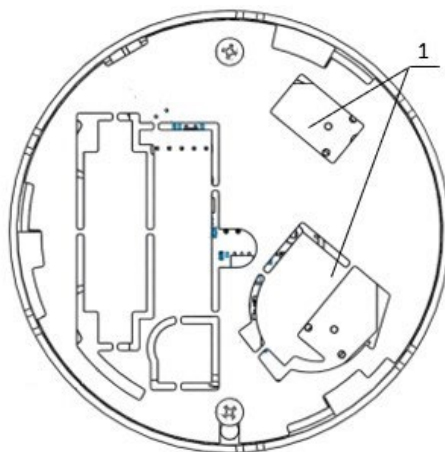
Рисунок 3 - Внутреннее устройство извещателя
